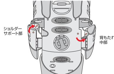
②背もたれ中部のクリップ（左右）とショルダーサポート部のクリップ（左右）を外します。
