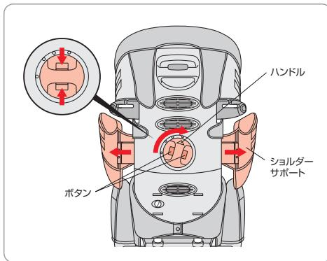
ハンドルのボタンを押した状態で、ハンドルを回してショルダーサポートを調節し、ボタンを戻します。
