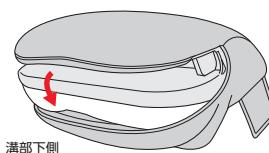
⑪溝部下側のシートカバーを外します。
