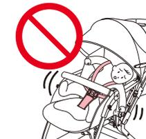
路面の溝にベビーカーの車輪がはまり、前のめりになるなどしてバランスがくずれベビーカーや使用者が転倒するおそれがあります。
