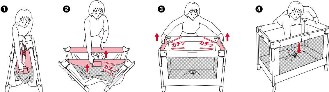
①本体を立て、上枠（前後）を持つ。②上枠（前後）を「カチッ」と音がするまで同時に引き上げ、ロックする。
