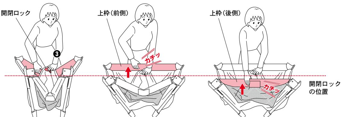
③開閉ロックを持ったまま、上枠（前後）を1本ずつ「カチッ」と音がするまで引き上げ、ロックする。上枠が確実にロックされ、折りたたまれないことを確認する。
