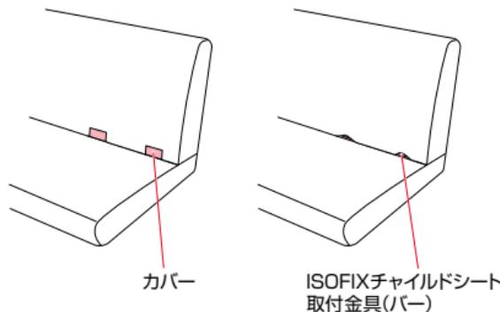
**2** ガイドキャップをISOFIXチャイルドシート取付金具(バー)に差し込み、取り付ける。(左右)
