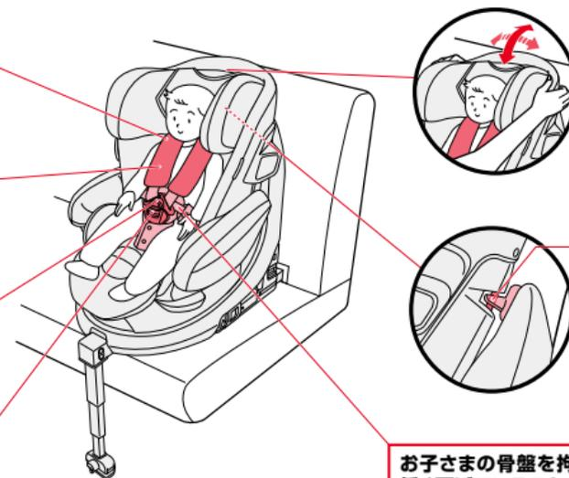
シートバック背面ロックがロックされていることを手で動かして確認すること。
